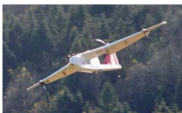
無人機が高度約200mから撮影した画像(右)。機体は全長1.6m、重量5kgで20分間飛行できる
