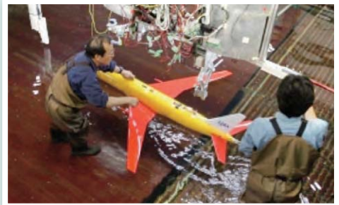
③ 吊り下げ装置に設置していただきました。ここをスタートに曳航し、水面に着水したのちに落下されます
