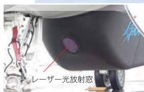
● 飛行実験用に搭載したシステム（高高度モデル） 当システムでは晴天乱気流だけでなく、低層ウィンドシア、山岳波など晴天時のほとんどの乱気流の検知が可能だ。
