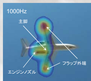
飛行中のジェット機から発生する騒音を計測して可視化したもの
