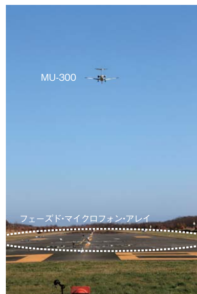
図3 滑走路上に置かれたフェーズドアレイ上空を通過する小型ジェット機MU-300
