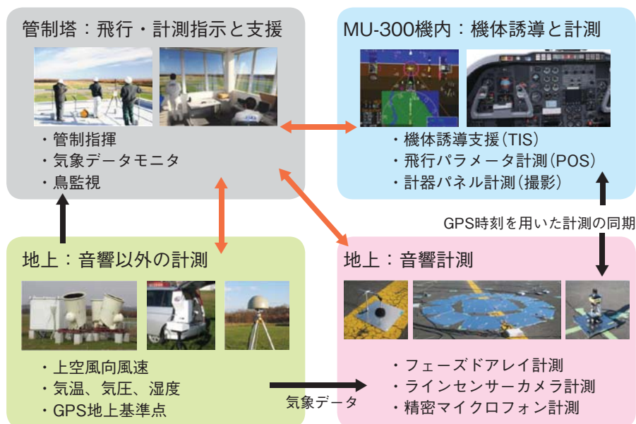
図2 試験システム全体の構成
