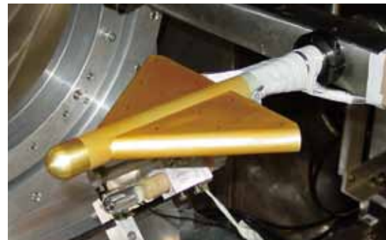
図5 AA-PSPコーティングを施した風洞模型
