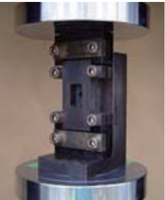
ISO規格となった有孔圧試験法治具 (ISO 12827)
